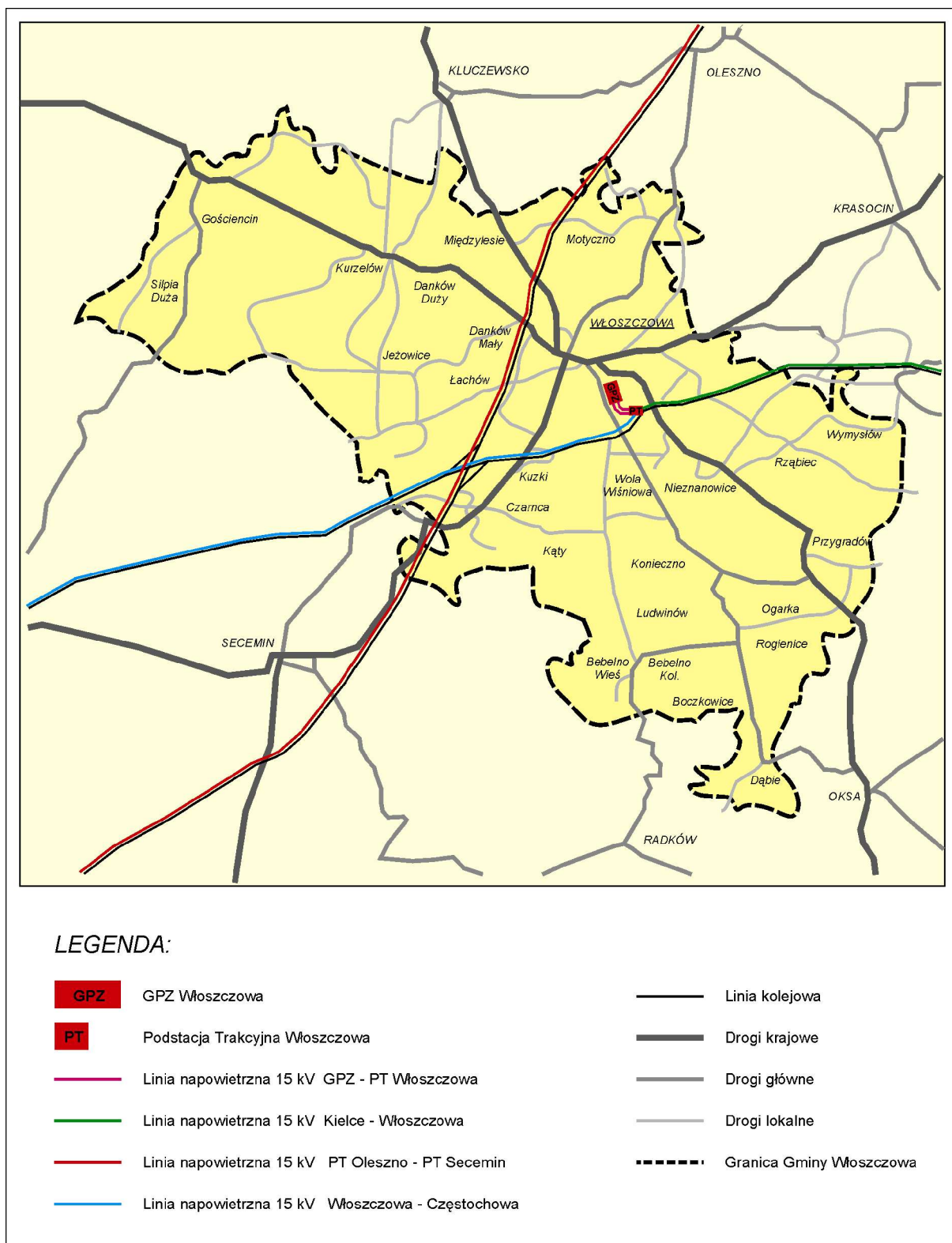
Rys.3.15. Linie napowietrzne 15 kV spółki „PKP Energetyka” na terenie Gminy Włoszczowa
